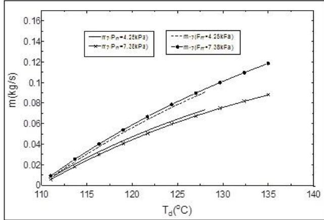
الشكل (3): كميات المبرد المنفصلة من المحلول في المولدين العلوي والسفلي مع درجة حرارة التشغيل المولد العلوي عند ( $P_H=62.50$  kPa,  $T_{cd}=87^\circ\text{C}$ ,  $P_L=0.87$  kPa).
